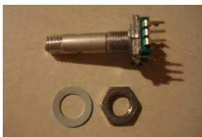
Figura 5: Modelo de encoder utilizado: STEC 11B04. Fonte: Lautenschlaeger (2008).
