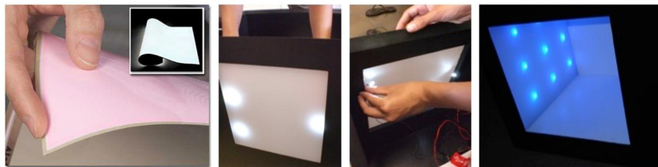
**Fig. 83:** Folha eletroluminescente: Como primeira opção de iluminação para a peça foram testadas folhas eletroluminescentes, uma opção interessante pelo efeito que proporciona e pelo baixo gasto de energia, porém seu uso foi descartado devido à dificuldade de aquisição e alto custo.
