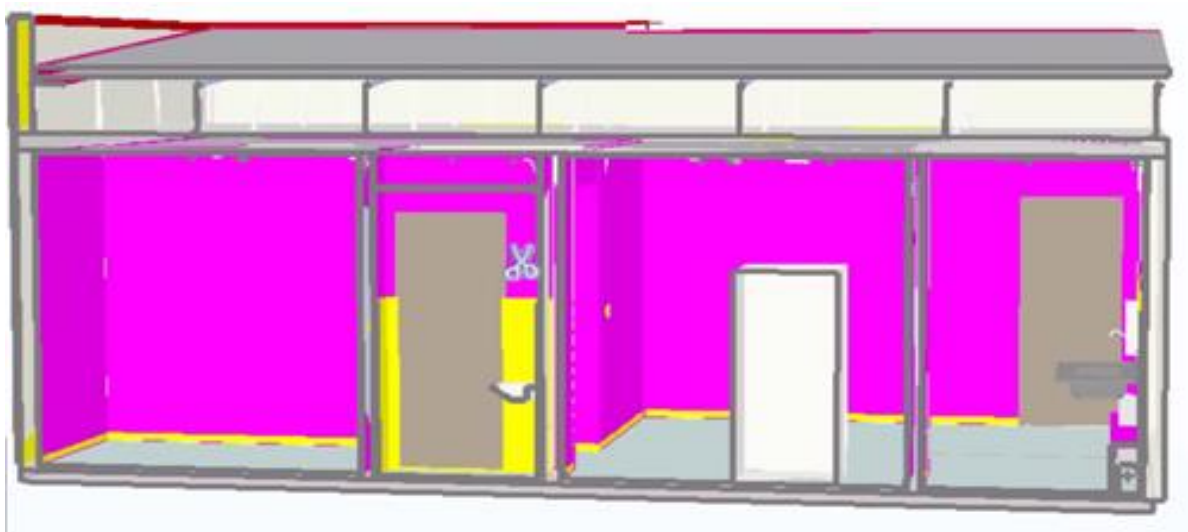
Figura 13. Visualização de planos de seção no modelo. Demonstração de uso da plataforma Tekla BIM Sight. Teste realizado em abril de 2018. Fonte: Arquivo da pesquisa (2018).
