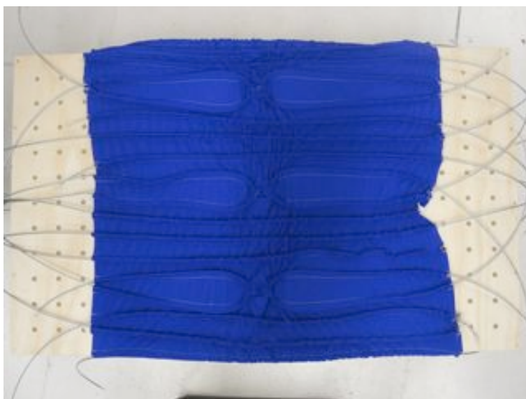
Figura 8. Padrão de costura para passagem dos cabos no elastano. Fonte: autores, 2011.
